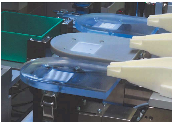
Modufeed® : système d'alimentation flexible.
